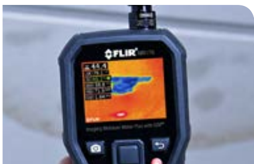
Detekcja problemów na wilgotnym suficie
